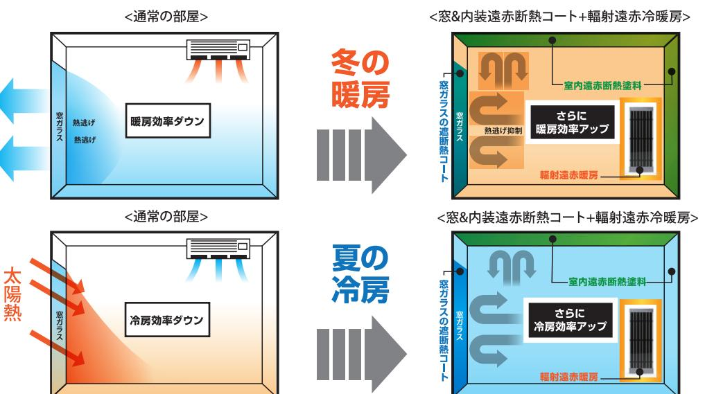
輻射遠赤冷暖房機から放射された遠赤外線は、遠赤外線が減衰されることなく吸収再放射するため、まんべんなくゆきわたり、室内にいる人間に吸収されます。内装遠赤コートに使用している遠赤セラミックの遠赤外線放射率は98%と高く、放射率が高いということはそれだけエネルギーがより多くの遠赤外線が熱に変換される為、遠赤効果が高いことになります。又、温度むらが起きず、室内の温度を均一にし、「省エネ」効果が期待できます。
